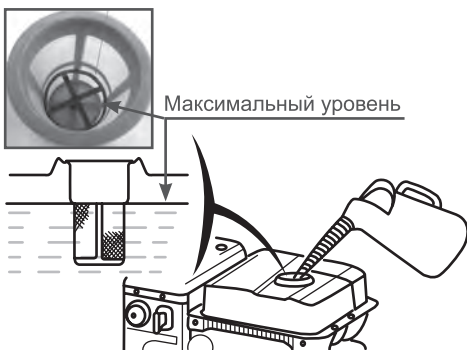
Рис. 8 Максимальный уровень топлива в топливном баке
