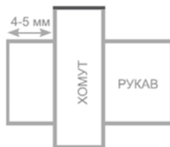
Рис. 6 Расположение хомута на рукаве
