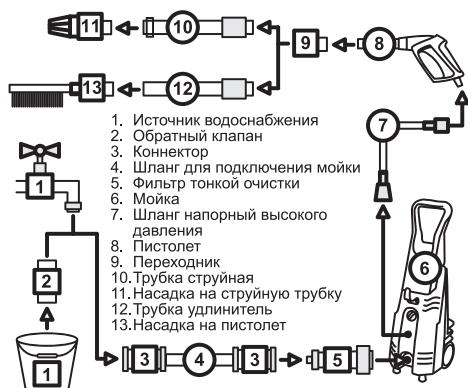
Рис. 12 Схема подключения аппарата мощного высокого давления с дополнительным оборудованием
