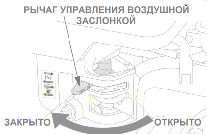
Рис. 30 Рычаг управления воздушной заслонкой
