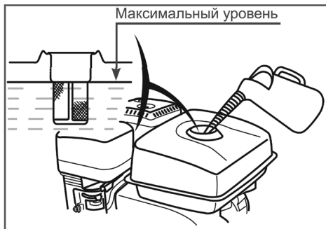
Рис. 5 Максимальный уровень топлива в топливном баке
