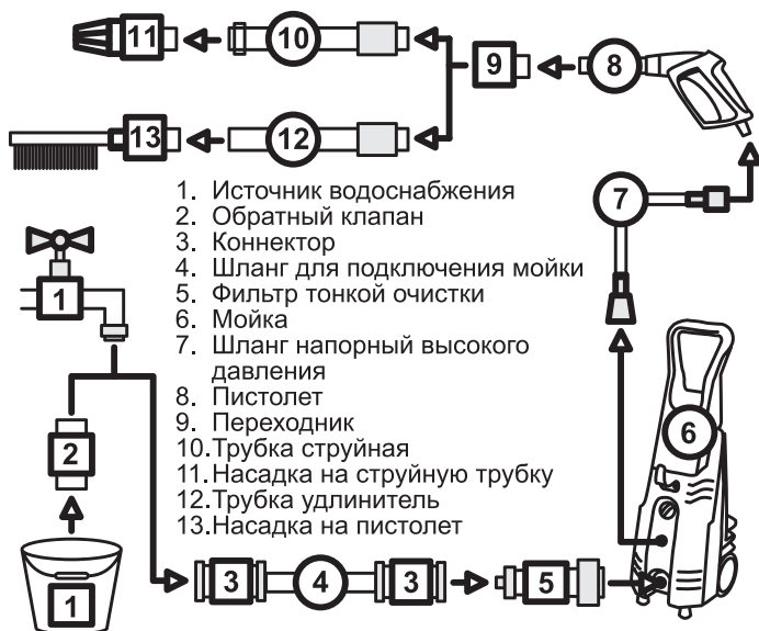
Рис. 13 Схема подключения аппарата с дополнительным оборудованием
