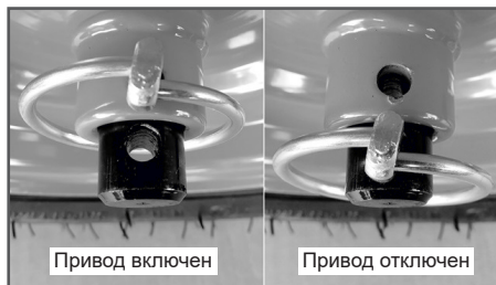
Рис.26 Перестановка шплинта на левом колесе
