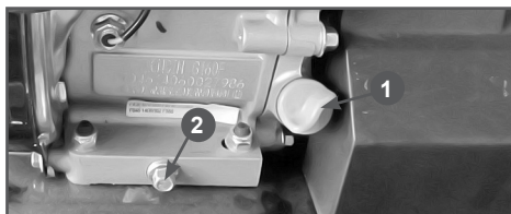
Рис.28 Замена моторного масла
