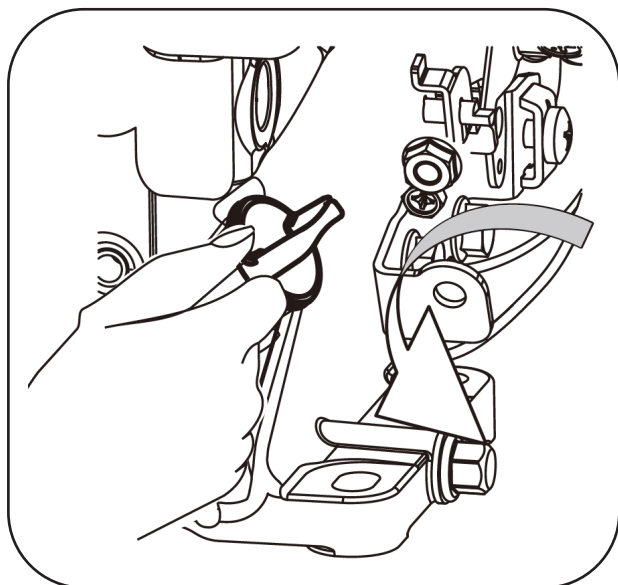
Рисунок 2. Проверка уровня моторного масла.
