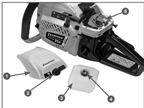
Рис. 21 Обслуживание воздушного фильтра
