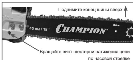
Рис. 5 Регулировка натяжения цепи
