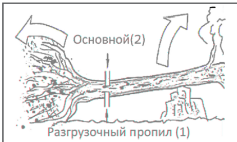
Рис. 19 Распиливание дерева, когда толстый ствол с комлевой частью находится под напряжением
