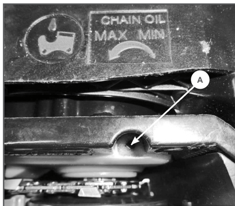
Рис. 13 Положение регулировочного винта подачи масла
