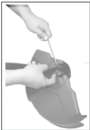
Рис. 3 Установка защитного кожуха
