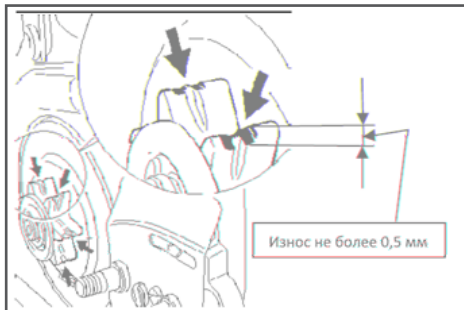
Рис. 23 Максимально допустимая глубина износа зубцов ведущей звездочки
