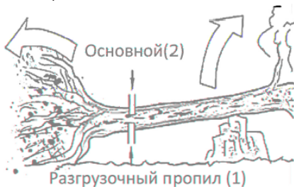
Рис. 14 Распиливание дерева, когда толстый ствол с комлевой частью находится под напряжением
