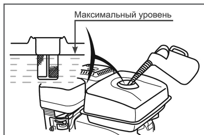
Рис. 11 Максимальный уровень топлива в топливном баке
