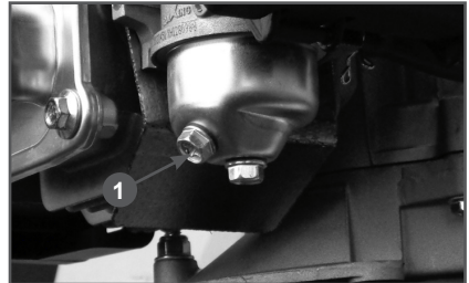
Рис. 20 Слив топлива с поплавковой камеры карбюратора
