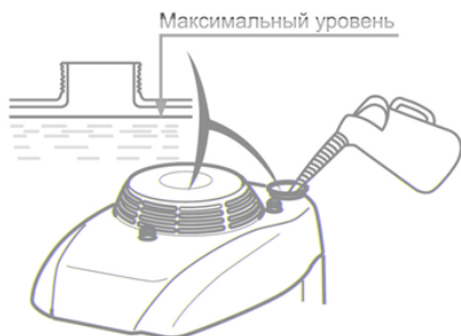
Рис. 14 Максимальный уровень топлива в топливном баке
