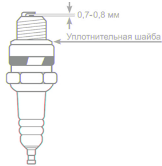
Рис. 20 Обслуживание свечи зажигания
