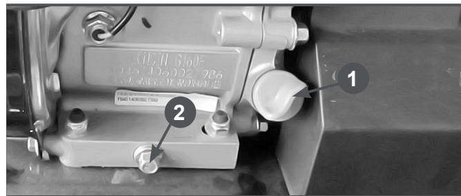
Рис.28 Замена моторного масла
