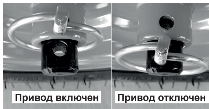
Рис.26 Перестановка шплинта на левом колесе
