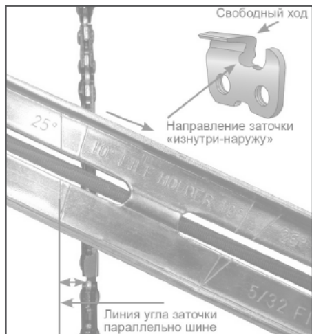
Рис. 28 Определение угла заточки
