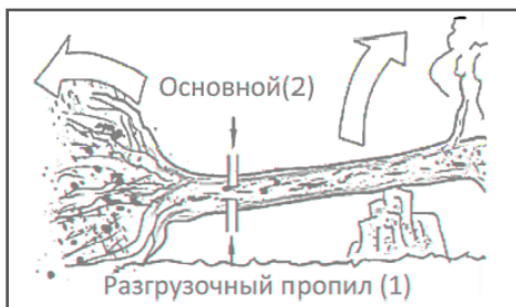
Рис. 18 Распиливание дерева, когда толстый ствол с комлевой частью находится под напряжением
