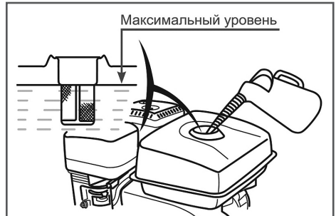
Рис. 6 Максимальный уровень топлива в топливном баке
