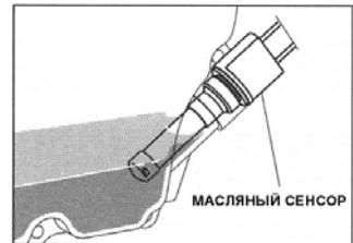
(б) Когда двигатель автоматически останавливается, отключите плавкий предохранитель генератора и проверьте уровень масла. Залейте масло в картер двигателя до максимального уровня, как указано на стр. 7 и запустите двигатель снова.
