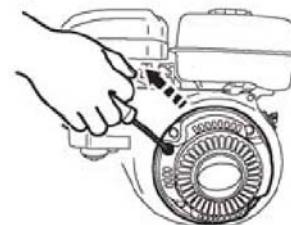
Если двигатель не запускается после нескольких попыток, повторите вышеупомянутые процедуры, предварительно переведя воздушную заслонку в открытое положение.
