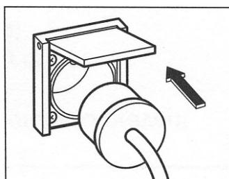
Вставьте вилку электрического устройства в розетку генератора.
