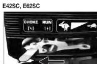
4. Переставьте воздушную заслонку карбюратора в положение CLOSE (Закрыто). Это не требуется, если двигатель уже разогрет.
