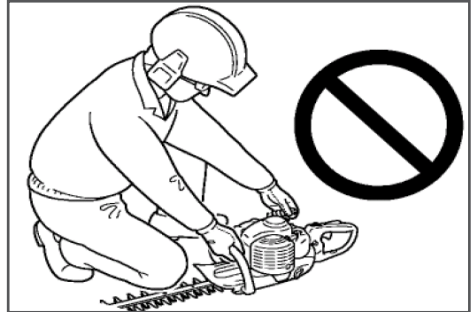
Рис. 4 Неправильное положение оператора при запуске двигателя
