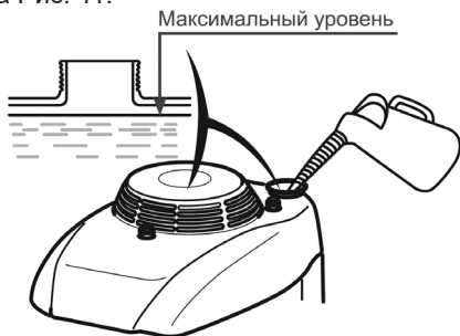
Рис. 11 Максимальный уровень топлива в топливном баке
