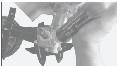
Рис. 20 Добавление смазки в корпус редуктора
