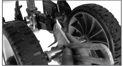
Рис. 6 Установка кронштейна колес
