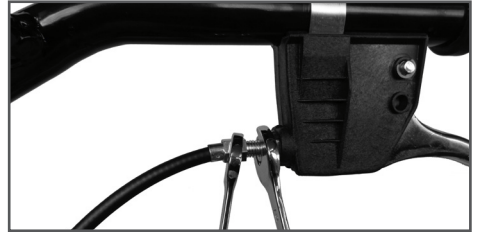
Рис. 10 Фиксация троса газа
