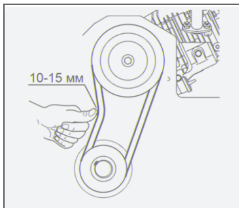
Рис. 23 Проверка натяжения ремня привода вибратора
