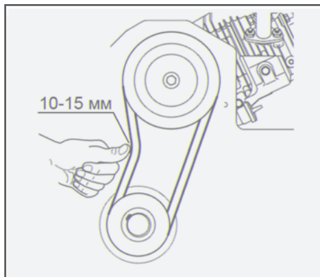
Рис. 23 Проверка натяжения ремня привода вибратора
