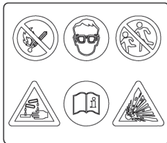
⑦ Наклейка Опасность аккумулятора
