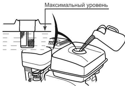
Рис. 5 Максимальный уровень топлива в топливном баке
