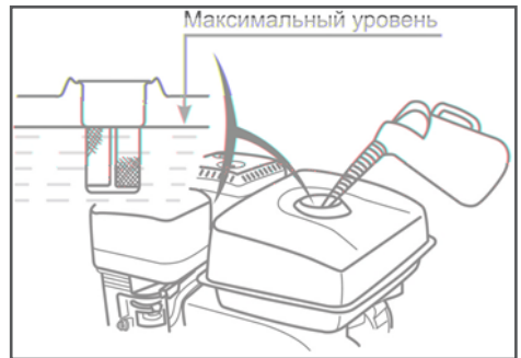
Рис. 12 Максимальный уровень топлива в топливном баке
