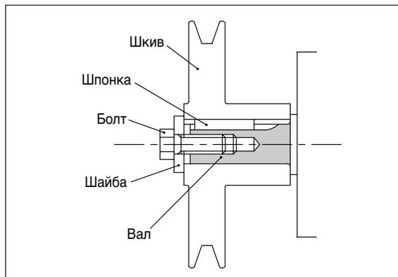
■ **Метрический коленчатый вал со шпоночной канавкой**
