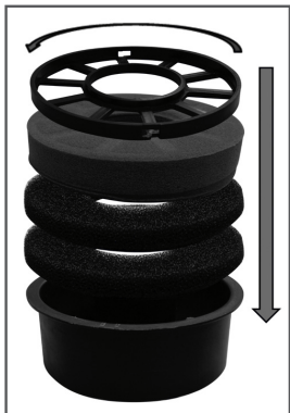
Рис.19 Установка фильтрующих элементов
