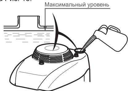
Рис. 13 Максимальный уровень топлива в топливном баке
