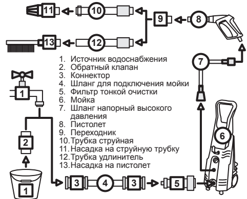
Рис. 11 Схема подключения аппарата моющего высокого давления с дополнительным оборудованием
