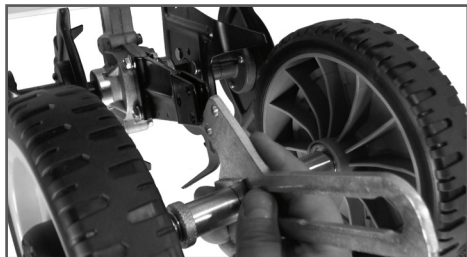
Рис. 6 Установка кронштейна колес
