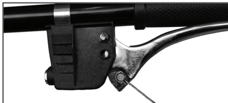
Рис. 9 Установка наконечника троса газа
