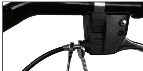
Рис. 12 Фиксация троса газа
