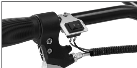
Рис. 13 Подключение проводов к выключателю зажигания
