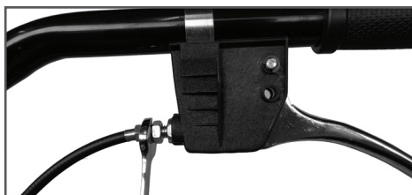
Рис. 10 Установка регулировочной муфты троса газа
