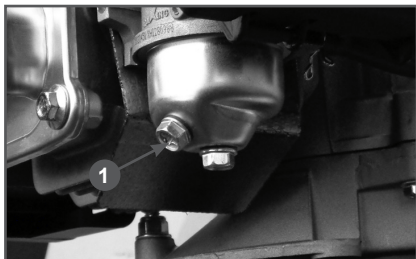
Рис. 22 Слив топлива с поплавковой камеры карбюратора 1. Болт
