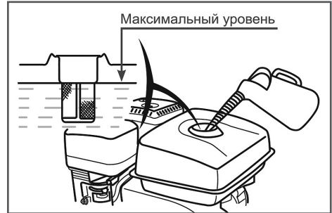
Рис. 13 Максимальный уровень топлива в топливном баке
