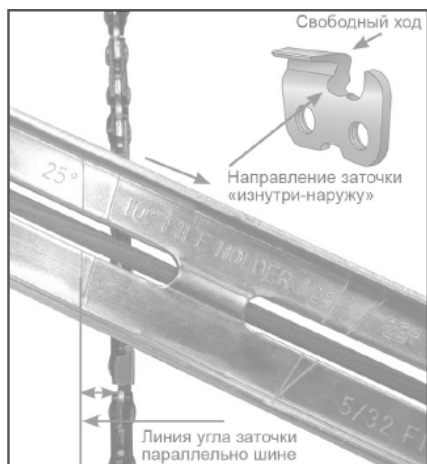
Рис. 18 Определение угла заточки
