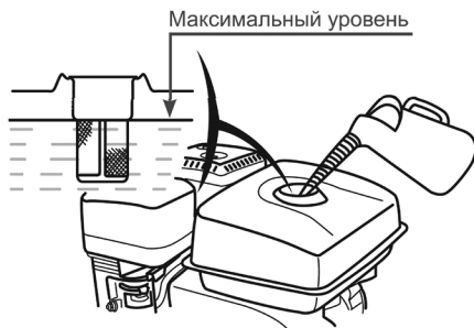
Рис. 5 Максимальный уровень топлива в топливном баке
