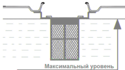
Рис. 5 Максимальный уровень топлива в топливном баке
