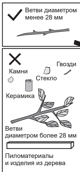
Рис. 11 Разрешенные и запрещенные для измельчения материалы
