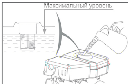
Рис. 2 Максимальный уровень топлива в топливном баке
