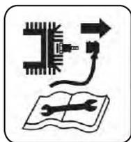
Перед обслуживанием отсоедините свечу зажигания
