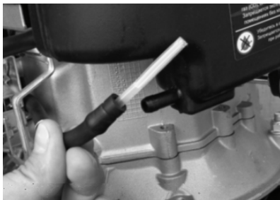
Рис. 17 Обслуживание топливного фильтра
