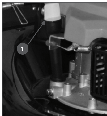
Рис. 10 Замена моторного масла
